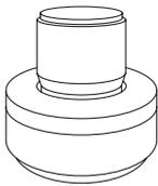
**2** Choisir la tête d'emboîture en fonction du diamètre du tube et la visser sur la pince ouverte.
