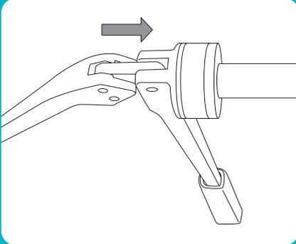
**3** Positionner la tête d'emboîture dans le tube. Ne pas utiliser d'étau pour maintenir le tube.
