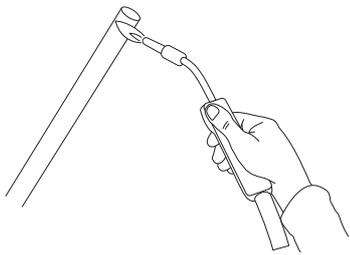
**1** Couper et ébavurer le tube. Recuire le pourtour du tube, si nécessaire, en tenant compte de la hauteur «h» de la tête d'emboîture.
