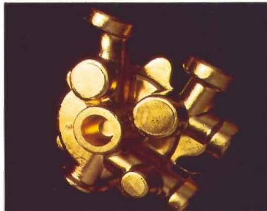
Pièce matricée brute en laiton pour la fabrication de corps de valve de chauffe-eau (Eurofac).
